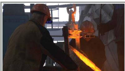
Шахтинский завод Гидропривод в 2013 году запустил линию по производству отливок из чугуна и стали от 5 до 600 кг., в формах размером 1200\*1000\*800 мм – в объеме до 500 тонн ежемесячно, с последующей полной механической и термической обработкой.
