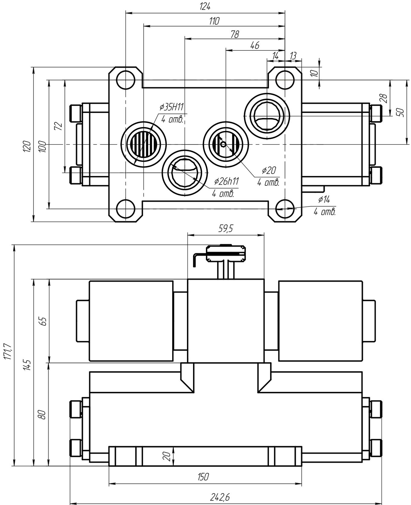
Рис.4 Габаритно-присоединительные размеры гидрораспределителей ШРЭ...-32
