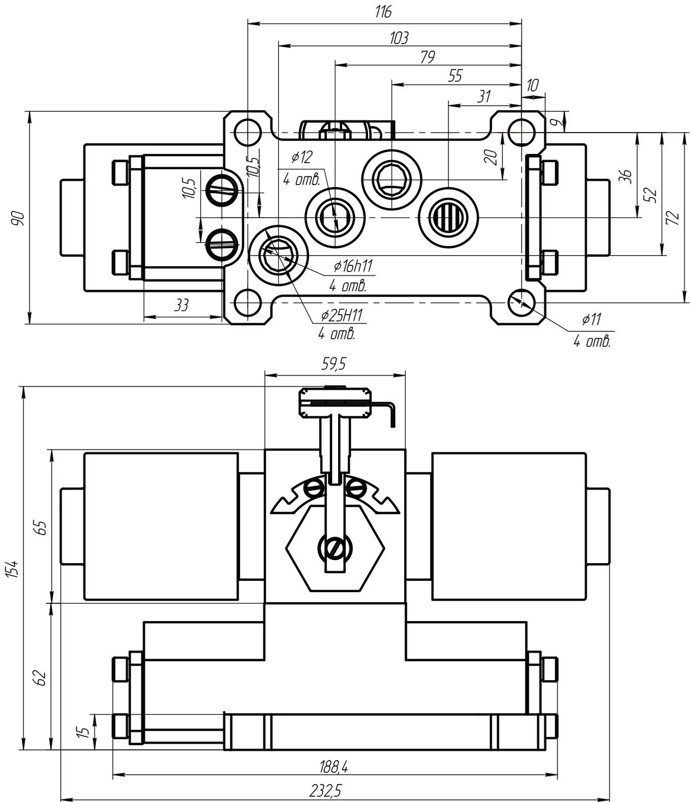
Рис.3 Габаритно-присоединительные размеры гидрораспределителей ШРЭ...-20
