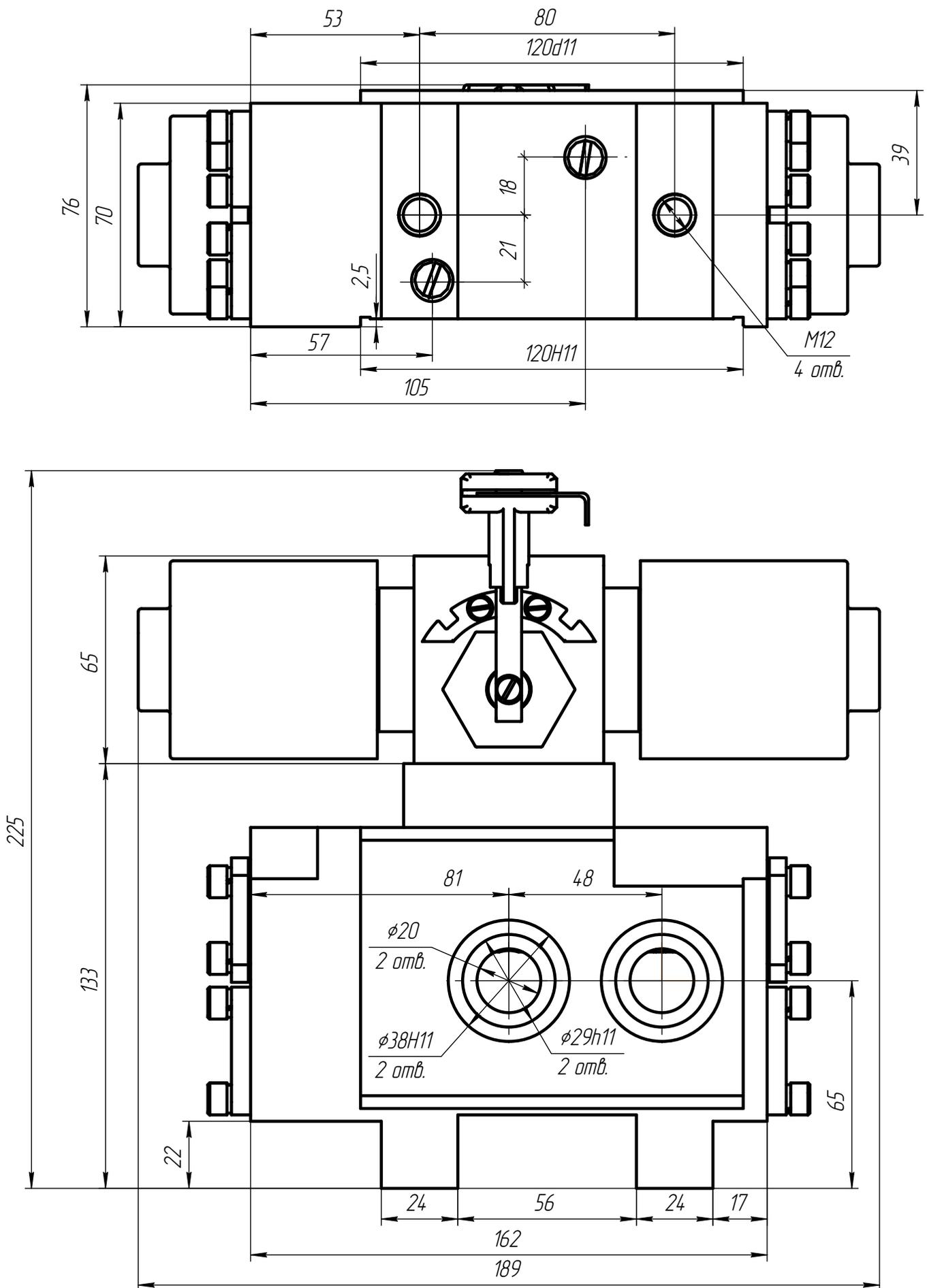
Рис.2 Габаритно-присоединительные размеры гидрораспределителей ШРЭ...-10
