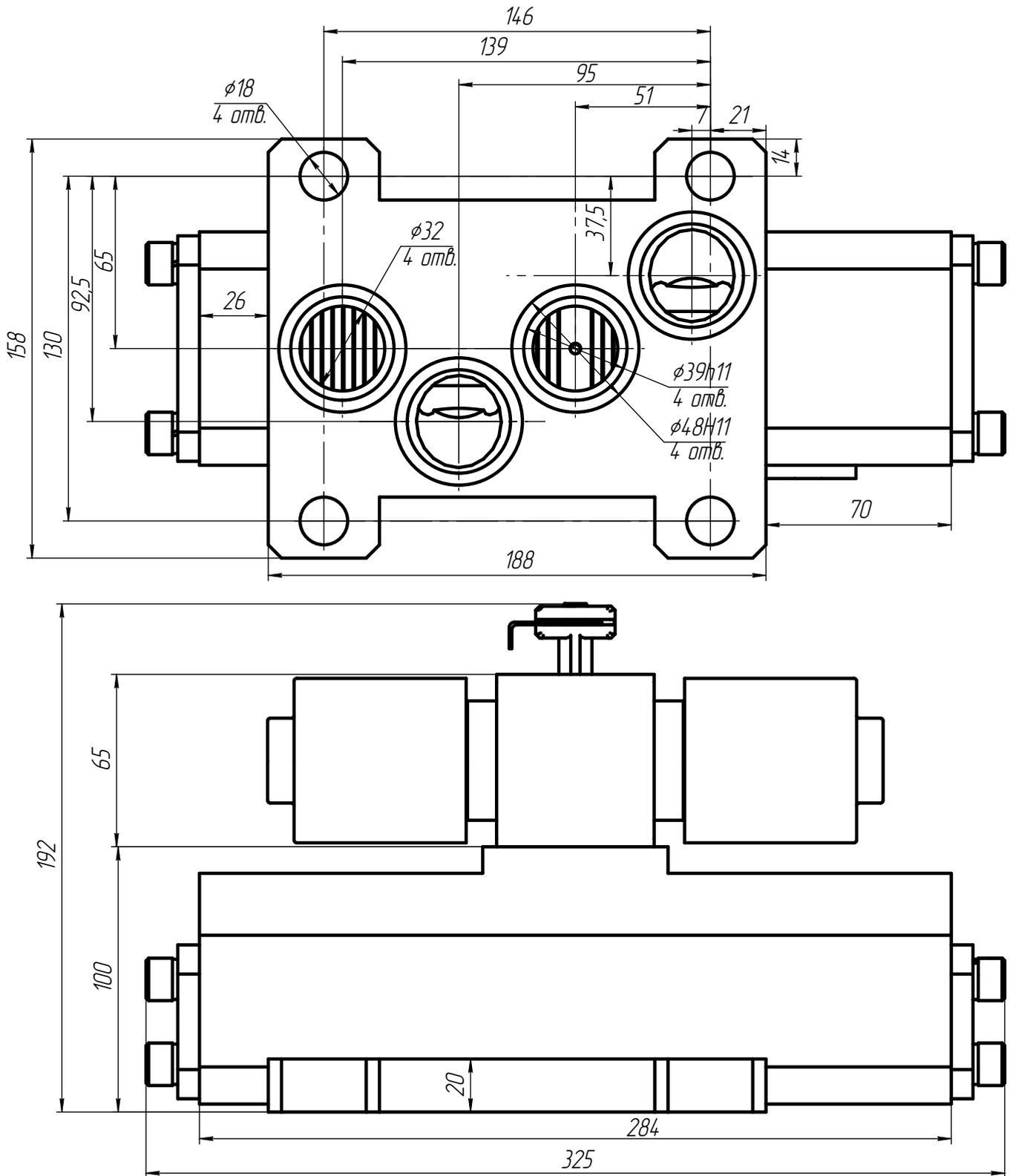
Рис.5 Габаритно-присоединительные размеры гидрораспределителей ШРЭ...-4
